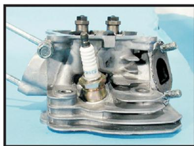
Конструкция двигателей Honda с верхним расположением клапанов не предусматривает охлаждение зон вокруг клапанных штоков. Температура блока головки цилиндра выше.
