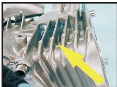
Воздух обдувает большие скошенные охлаждающие ребра на блоке цилиндров, обеспечивая эффективное охлаждение. На данную систему подана патентная заявка.
