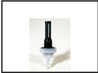
В двигателях Honda используется топливный фильтр меньшего размера и отстойник, который необходимо снимать для проверки наличия загрязнения.
