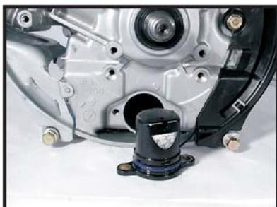
В датчике масла в двигателях Robin Subaru применен поплавковый рычажного типа, обеспечивающий максимальный срок службы. Датчик выдержит паузу 5 секунд перед выключением зажигания. Расположен на передней части двигателя для легкого доступа.
