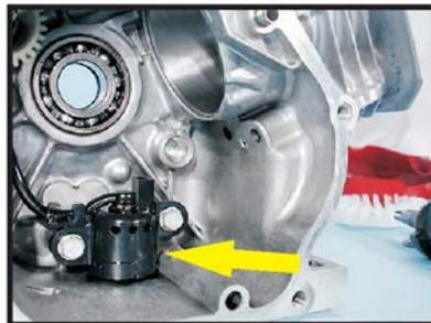
В двигателях Honda применяется стандартный поплавковый датчик без функции прерывания зажигания. Замена очень затруднена. Для доступа необходимо снять крышку шестерни.
