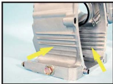
Охлаждающие ребра отлиты на внутренней и на внешней сторонах картера на каждом участке, требующем охлаждения.
